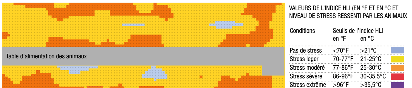
Figure 5. Cartographie « thermique » d'un bâtiment à partir de l'utilisation du HLI
