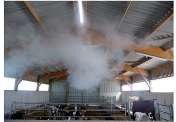
Observation du circuit d'air par fumigène
