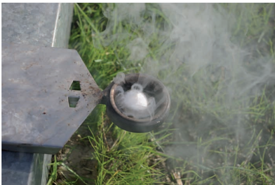
Lorsque l'appareil atteint la température adéquate, l'acide oxalique se sublime.
